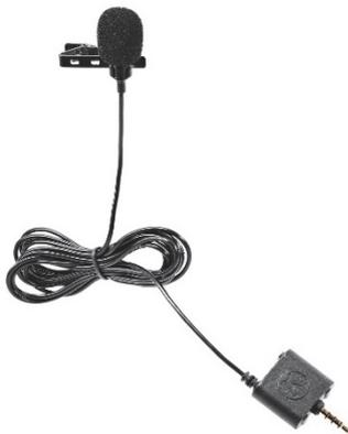
MiCreator Y-Lav ist ein analoges Lavalier-Mikrofon mit einem 2m langen Kabel mit 3.5mm TRRS-Klinkenstecker zur Verbindung zu einem Endgerät (wie z.B. Computer, Tablet, Mobiltelefon etc.). Über eine 3.5mm TRS Buchse kann auch ein Kopfhörer angesteckt werden. Sein volles Potential entfaltet MiCreator Y-Lav in Verbindung mit dem MiCreator Studio.
