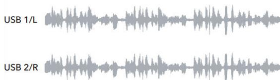
MiCreator Studio wird vom Endgerät als Stereo-Audiogerät erkannt. Sofern kein weiteres Zubehör am MiCreator Studio angeschlossen ist, wird über die USB-C® Verbindung das Mikrofonsignal immer am linken und rechten USB-Kanal übertragen.
