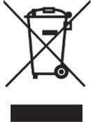
Am Ende der Lebensdauer des Produkts, trennen Sie Gehäuse, Elektronik und Kabel und entsorgen Sie alle Komponenten gemäß den örtlichen Abfallentsorgungsbestimmungen.
