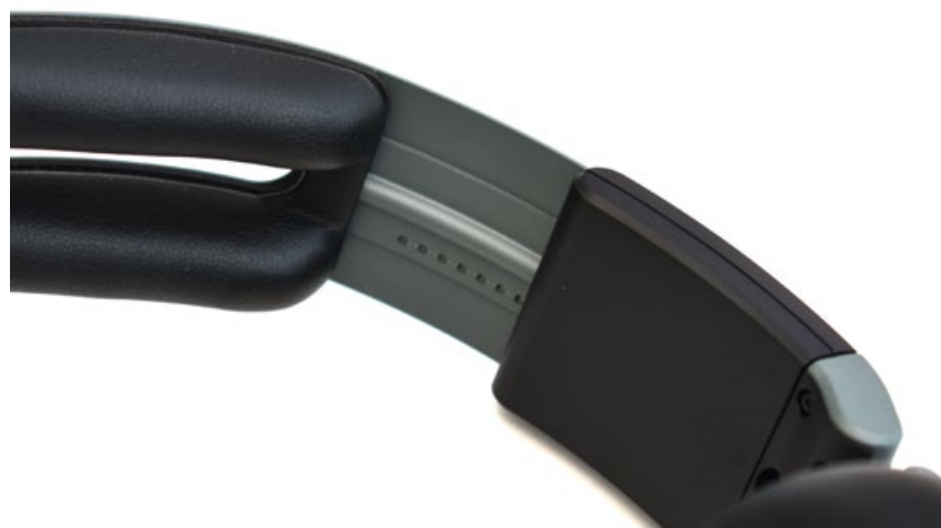
Zehn Einstellungsmöglichkeiten stehen pro Seite zur Verfügung und machen den Hi-X65 auch für Menschen mit großem Kopfumfang sehr bequem.
